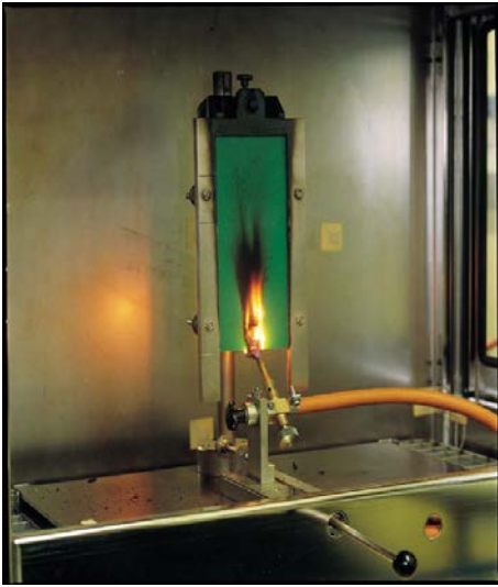
Abb.2: Kantenbeflammung Fig.2: Edge flame impingement
