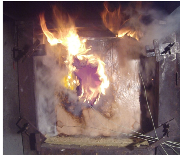
Abb. 6: Einbaubeispiel DIN 4102-8 Fig. 6: Installation example DIN 4102-8
